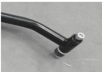
Tornillo + reductor de agujero + arandela nylon + tubo de plástico + arandela de metal + tuerca autoblocante.
