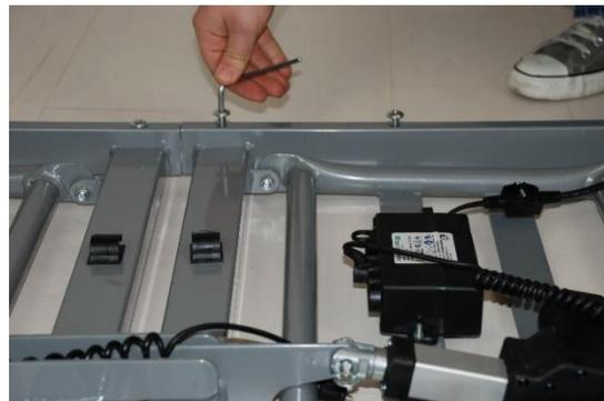
Deje la estructura montada en el suelo e instale el cabecero. Para hacerlo bloquee primero los frenos de las ruedas y asegúrese de que los mecanismos de retén con muelle estén abiertos. Coloque la estructura en su alojamiento y asegure los tornillos.
