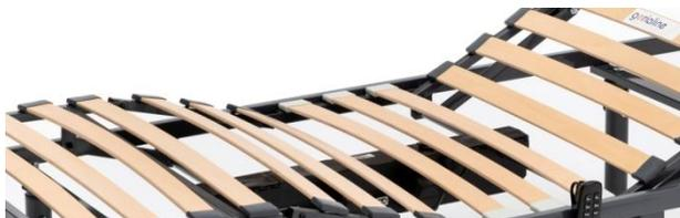
El lecho está fabricado en tubo de acero dividido en secciones de 20x20x1.5 mm y 40x20x1.5 mm, con un acabado en gris grafito. El lecho a su vez cuenta con 2 alojamientos reforzados con piezas termoplásticas naranjas instalados en la cabecera, para el alojamiento tanto de incorporador como de portasueros.
