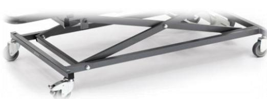
Cuenta con 4 ruedas de 100 mm de diámetro y banda de goma, de las cuales 2 de ellas cuentan con sistema de frenado. El carro cuenta con la altura al suelo suficiente para permitir el uso de grúas de traslado.
